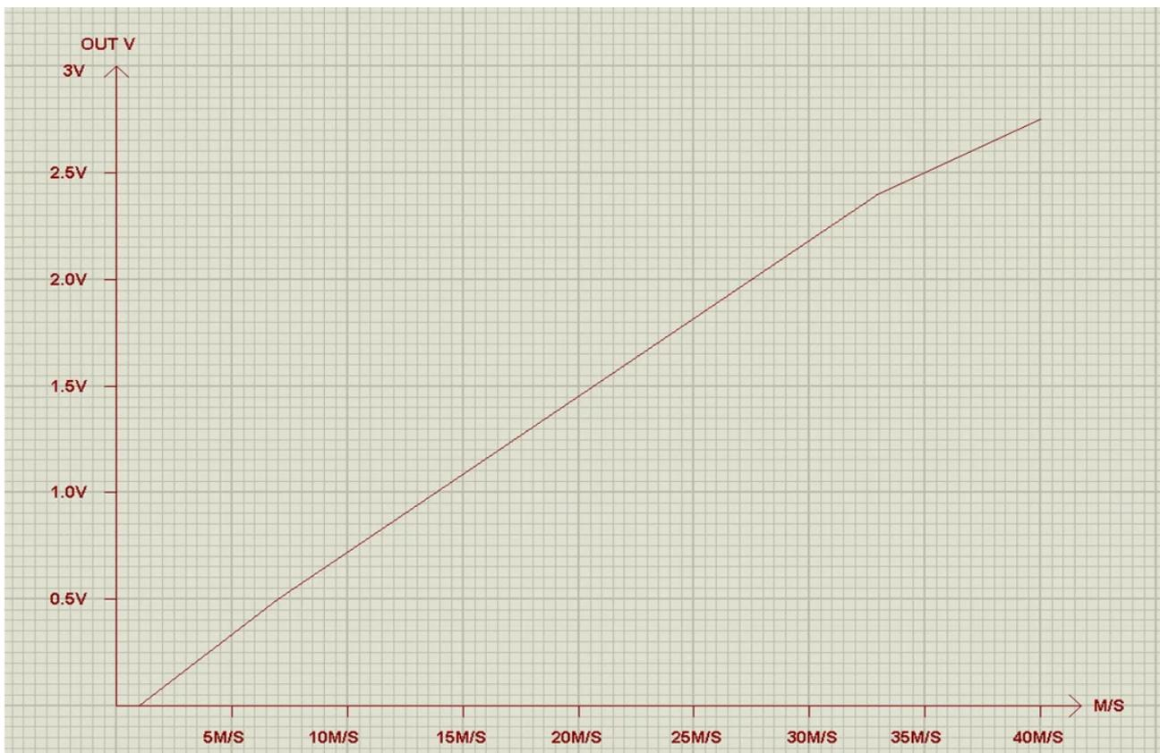
**L'axe horizontal représente la valeur de la vitesse du vent (M/S) en mètres par seconde, et l'axe vertical représente la valeur de tension du signal de sortie (V)**
